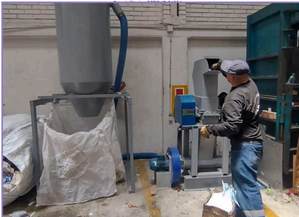
Fotografía 7. Implementación molino triturador en la ECA principal. Fuente: Asociación Pedro Leon Trabuchi.
